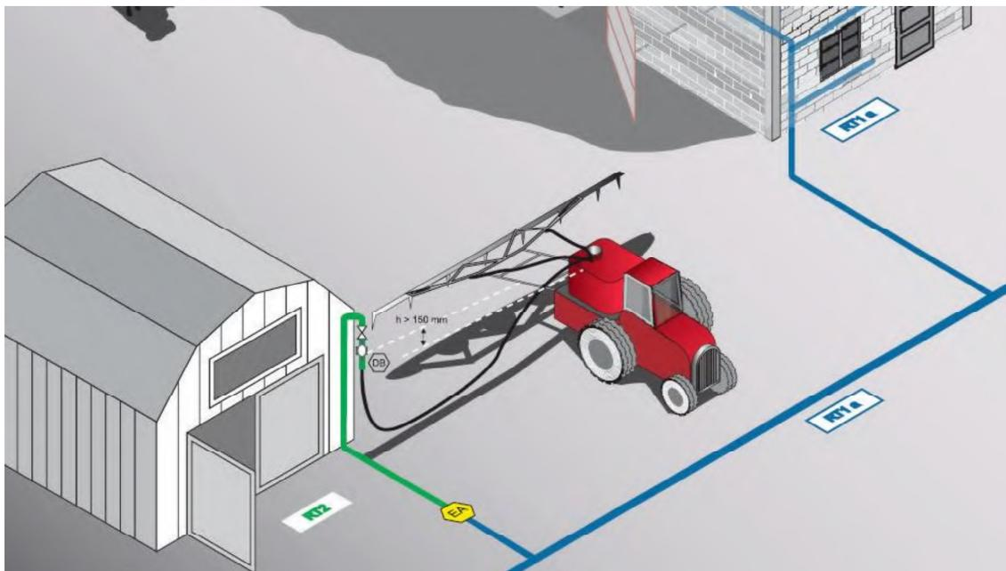
**Figure 1 : Illustration d'un exemple de mesures de protection des réseaux d'alimentation en EDCH pour une exploitation agricole, Source : Centre scientifique et technique du bâtiment, 2004**
